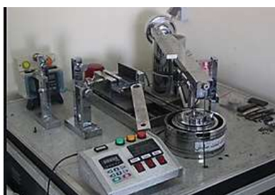
شکل ۸- دستگاه آزمون سایش پین روی دیسک
