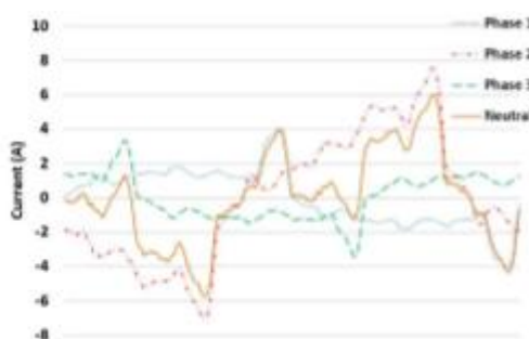
شکل ۸. جریان‌های کشیده شده توسط ده برج دستگاه ماینر و یک سرور
